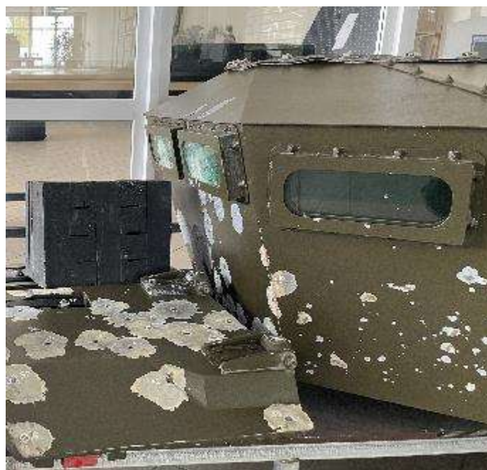
Рис. 1. Привлечение курсантов к реализации испытаний по исследованию бронезащищенности боевых бронированных машин
