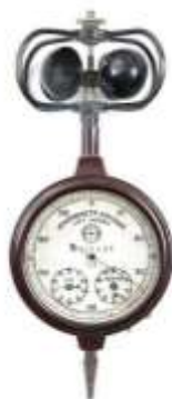
Рис. 2. Анемометр ручной чашечный со счетным механизмом МС-13
