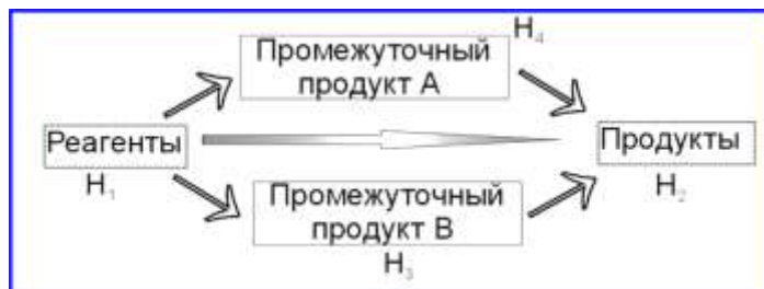
Рис. 1. Обобщенный химический процесс превращения реагентов в продукты реакции, который может быть осуществлен различными путями в одну или несколько стадий
